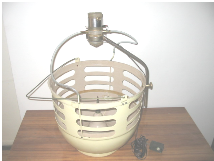
2 pav. Aparatas UEA-5 naudojamas profilaktiškai gydyti ir dezinfekuoti 1–80 mkm dydžio elektroaeroliniais
